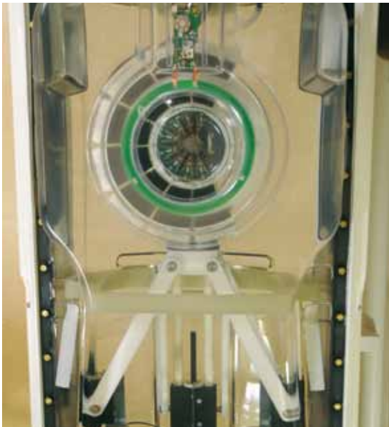
Figuur 2. Close-up van de tafel van het borststelsysteem, waarbij de transducers rondom de kom duidelijk zichtbaar zijn. Patiënten zullen tijdens de MR-HIFU-behandeling op hun buik liggen terwijl de aangedane borst in de kom hangt.
